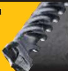
Fino a Ø 14mm testa piena in carburo saldata al laser, da Ø 16mm in poi testa al carburo brasata al corpo della punta per una maggiore resistenza.
